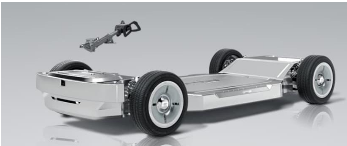
Module banalisé CIIC skateboard à quatre roues motrices comportant chacune un moteur électrique. A équiper à la demande avec plancher totalement plat incluant les batteries. Photo CATL - Via internet.
